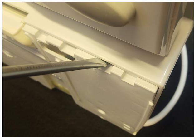
Das Oberteil und das Unterteil sind durch Klick-Klemmungen verbunden, die Sie jetzt mit Hilfe des Schraubendreher öffnen können. Das Schraubendreher-Symbol zeigt Ihnen den richtigen Punkt, an welchem Sie den flachen Schraubenzieher ansetzen können.
