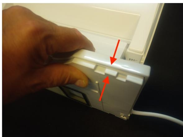
Zum Schließen verbinden Sie die Bodenplatte wieder mit dem Oberteil.
